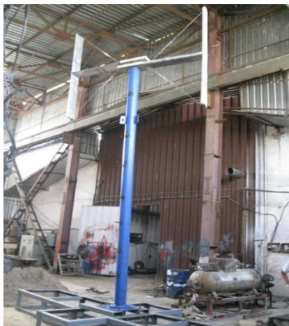
Рисунок 5 – Комбинированная ветроустановка НВИ-ротор карусельного типа полупромышленного образца
