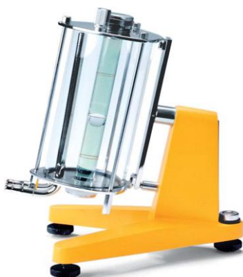
Сурет 1 – Сұйықтың тұтқырлығын анықтауға арналған Хепплер вискозиметрі шариктерімен.
