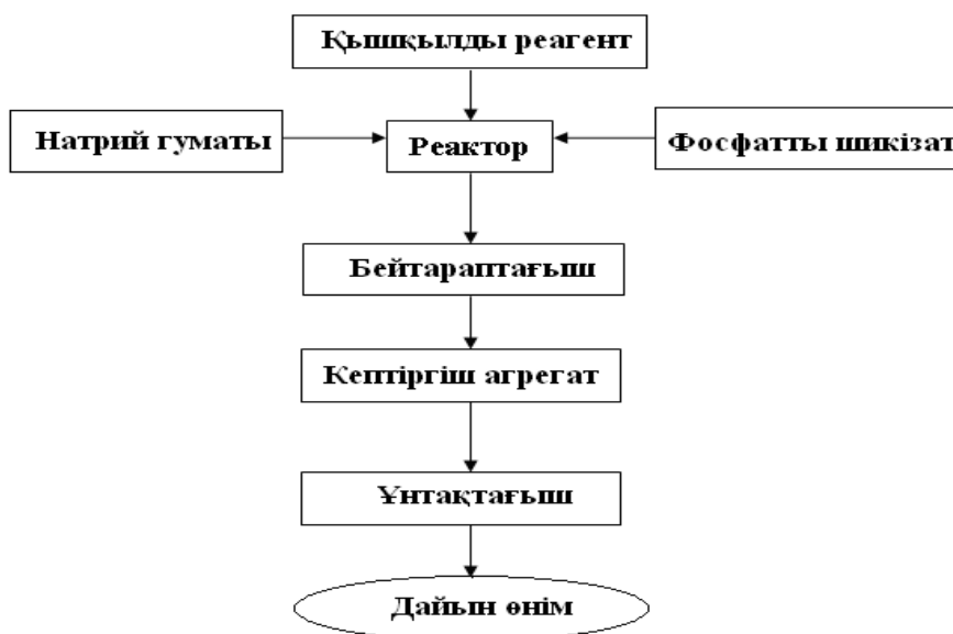
1-сурет. Құрамында гумат бар тыңайтқышты алудың технологиялық сызбасы
