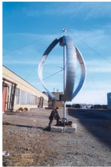
Рис. 2. Ветроагрегат Дарье системы тропоскино.
